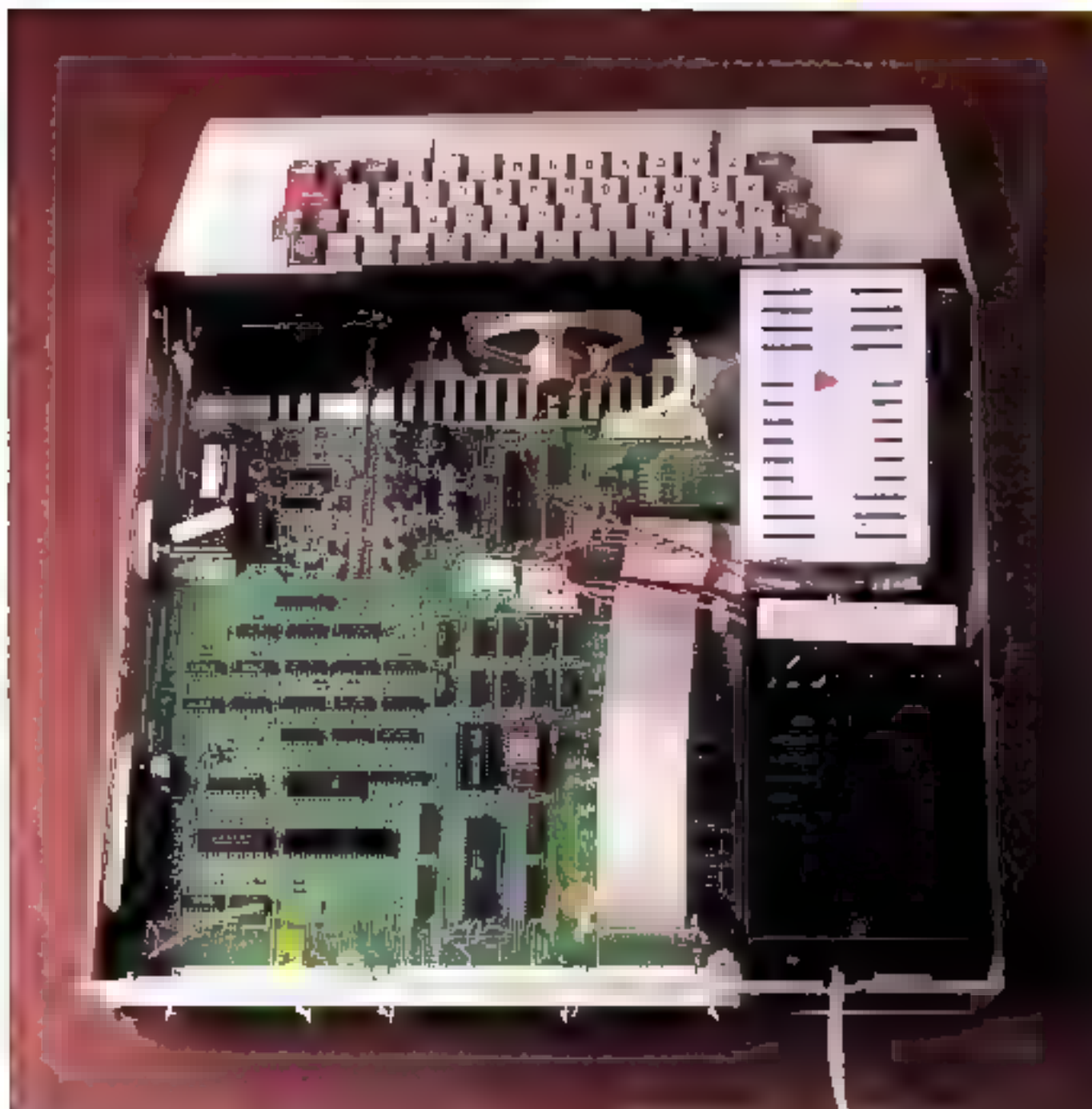
L'ensemble de l'Einstein tient sur un circuit double face de bonne qualité
